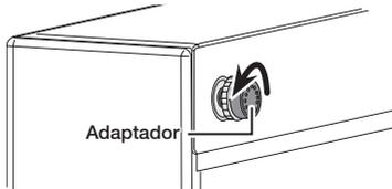
2. Una vez ajustado el espacio entre la puerta y el refrigerador, gire la tuerca del adaptador en el sentido de las agujas del reloj (↻) para bloquear el adaptador en su lugar.
